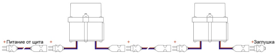
Соединение гирлянды огней кольцом для снижения потерь тока в длинных кабелях и повышения защиты светосигнального оборудования от аварийных разрывов электрической цепи. В гирлянду с подключением кольцом допустимо соединять до 24 огней и кабели подключения к щиту до 100 метров.
