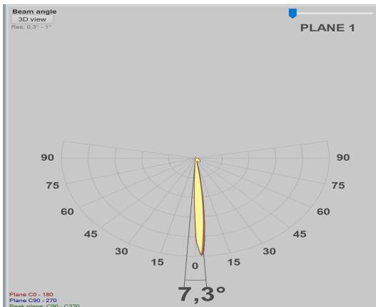
В вертикальной плоскости прожектор имеет мощный узкий луч, не слепящий пилота на посадочной площадке (ниже 0 градусов) и обеспечивающий освещённость 10 люкс на дистанции 15 метров от прожектора.
