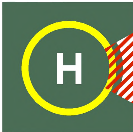
Рис. 5-7. Маркировка запрещенного для посадки сектора вертопалубы
